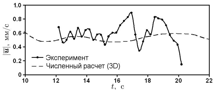
Рис. 8.14. Зависимость максимальной осредненной скорости (численный расчет) и средней скорости одной твердой частицы (эксперимент) от времени.
